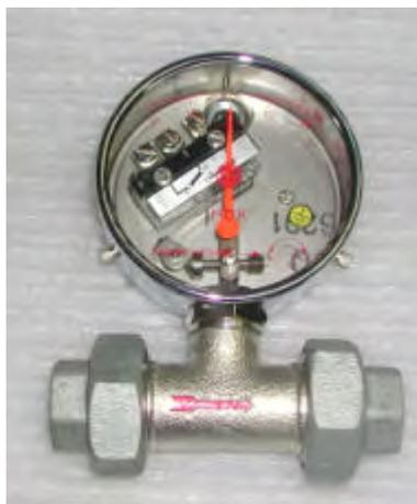
Mit Durchflußanzeige und Skala sind eine Neukonstruktion nach dem Steuerkolbenprinzip, auch für extrem geringe Durchflußmengen reiner, neutraler Medien wie Wasser, Öl, Luft mit Temperaturen bis 80° C bei einem Leistungsdruck von 0 - 10/16 bar, auch zeitweise drucklos ohne Nachteil.
